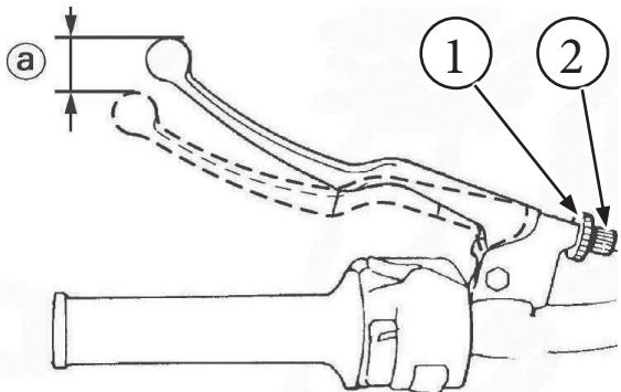
Для регулировки хода ослабьте контргайку (1) и вращением против часовой стрелки регулировочного винта (2) натяните трос так, чтобы рычаг парковочного тормоза имел свободный ход в пределах 5-10 мм.
