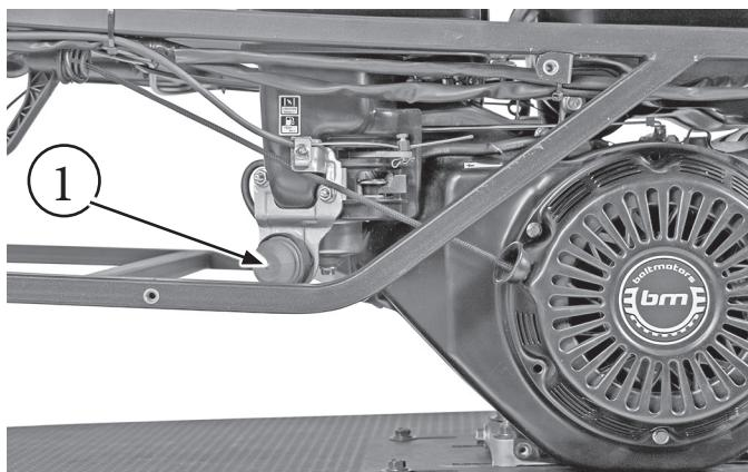
Праймер (1) предназначен для облегчения запуска двигателя мотобуксировщика.
