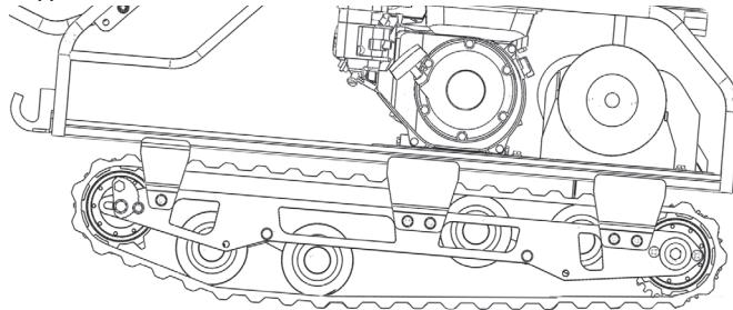
Мотобуксировщик наклоняется вперед и проседает, падают тяга и скорость. Двигаться в таком режиме нельзя. Тележку необходимо повернуть в рабочее положение.
