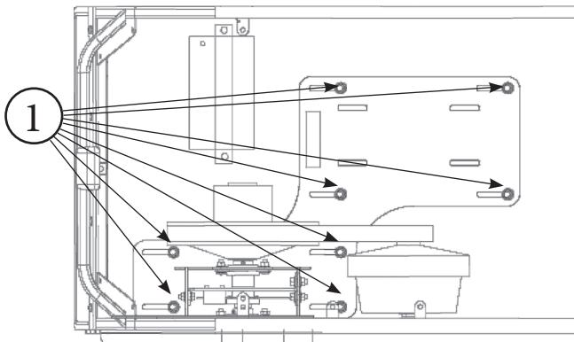
Сдвиньте мотораму вместе с двигателем для натяжения или ослабления цепи.
