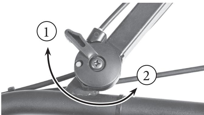
Переведите рычаг управления воздушной заслонкой в положение (1) – заслонка открыта (используется при движении мотобуксировщика).
