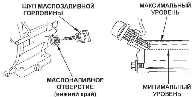
Выкрутите щуп маслоналивной горловины и протрите его.
