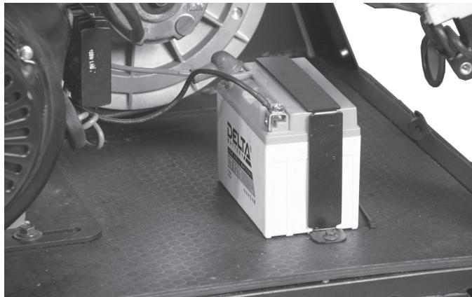
Аккумулятор не входит в комплектацию мотобуксировщика. В мотобуксировщик может быть установлен аккумулятор Delta CT 1211 (12V/11Ah) или его аналоги: YT12B-BS, YTZ14S.
